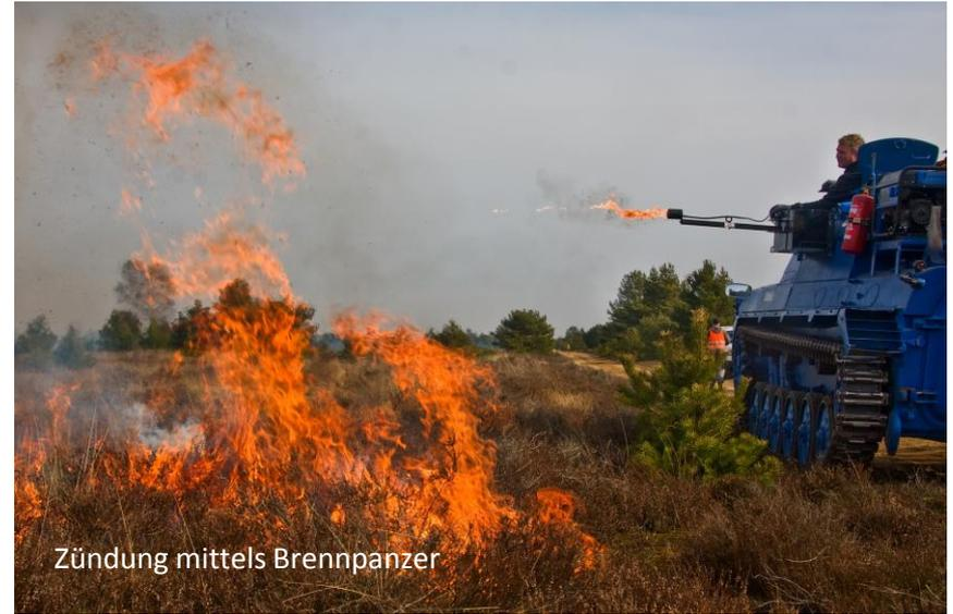
Zündung mittels Brennpanzer
