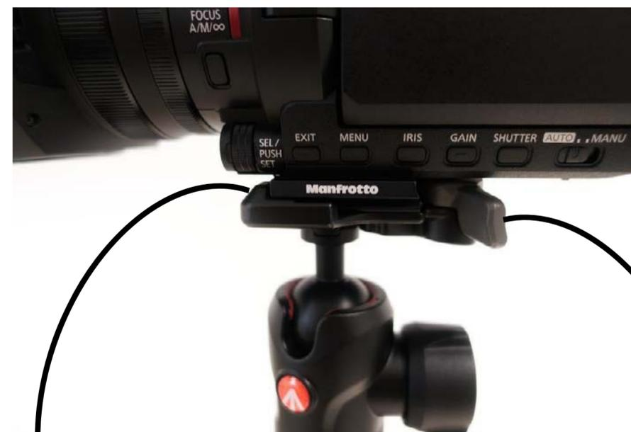
Kamera in Führungsschiene schieben + loslassen
