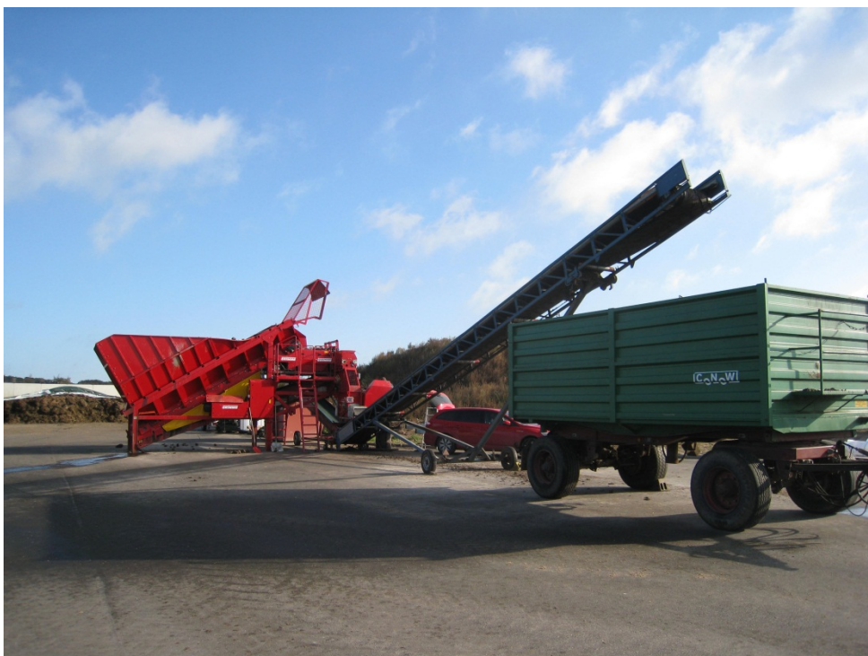
Entsteinen und Bröckeln der silierten ganzen Rüben vor dem Einbringen in die Biogasanlage
