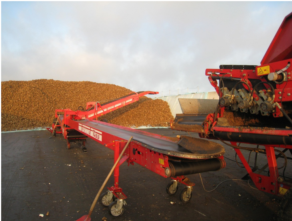
Einlagerung der ganzen Rüben in ein Fahrsilo, zuvor werden die Steine ausgesondert, ca. 7 m Stapelhöhe
