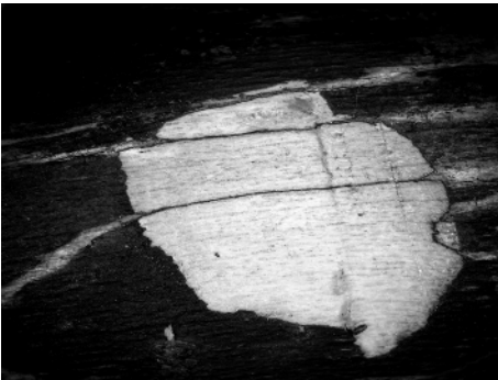
Abb. 3: Die Oberfläche wurde entfernt, die Trennschichten im Holz werden unter der hellen Musterung sichtbar
