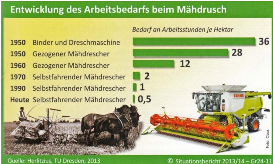
Abb. 5: Arbeitszeitersparnis durch Mechanisierung am Beispiel des Mähdruschs.
