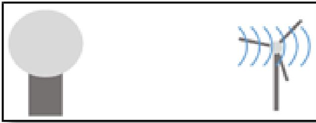
Abbildung 1: rechts: WRA sendet Radarpulse, links: Radarpulse trifft auf WEA und erzeugt dabei störendes Echo.
