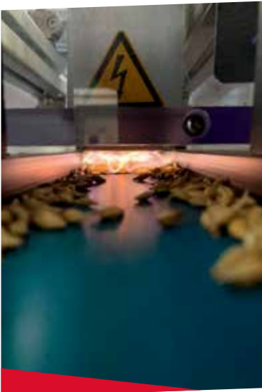
Physikalische Behandlung von Getreidekörnern mit atmosphärischem Kaltplasma (Bündnis: Physics for Food), (Foto: Paulina Druse)
