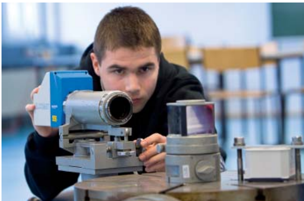
Einrichten eines elektronischen Autokollimators in der industriellen Messtechnik (Foto T. Mandt)
